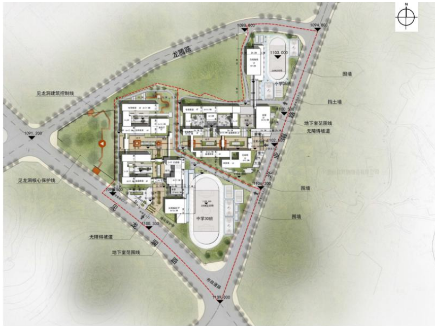
图 2-3 贵州双龙航空港经济区龙腾中学建设项目土地使用规划图
